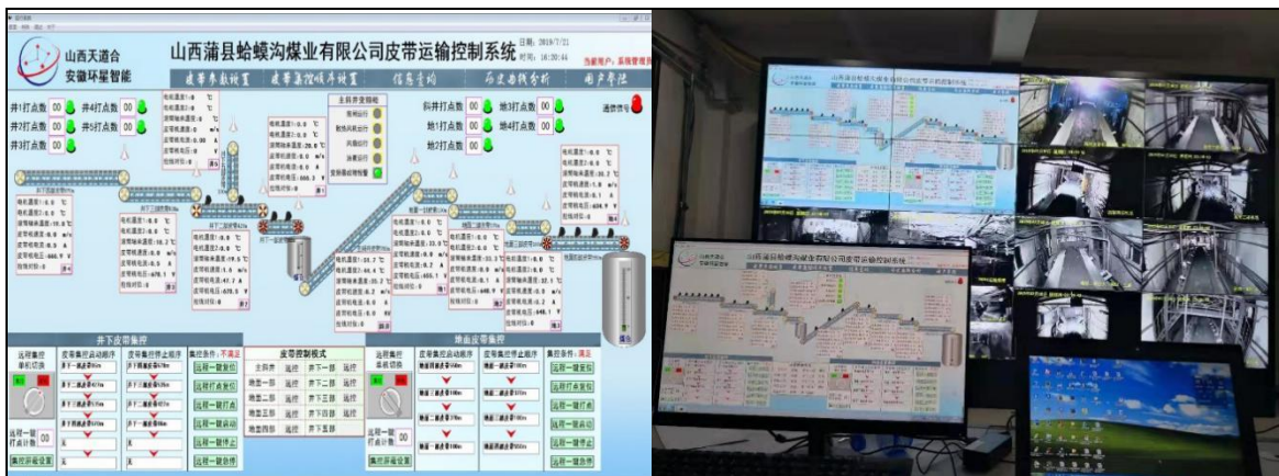
图 3-10 师生承担企业技术攻关——皮带运输机控制系统示意图
